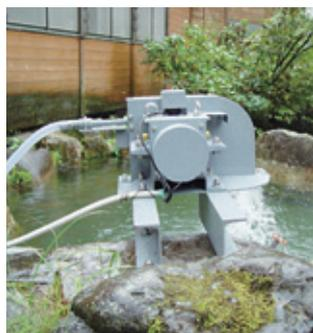
新潟県魚沼市の「駒の湯山荘」に設置された水車は、自噴する温泉水をジェット噴流化して羽根を回すことで発電する仕組みです。
