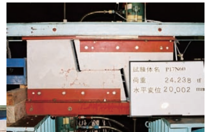
ジョイント部実験
