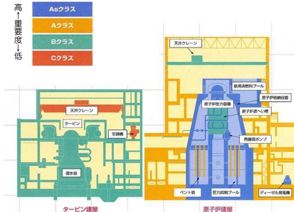
BWR型原子力発電所の耐震設計上の重要度分類
