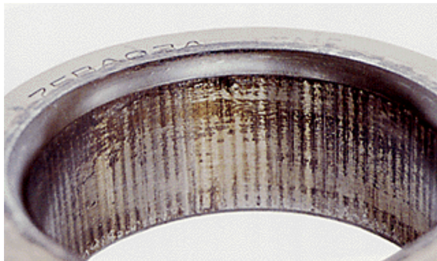
アンギュラ玉軸受の内輪 内径面全周に生じた著しいフレッチング しめしろの不足によるもの
