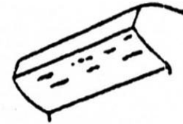
(d) 腐食摩耗
