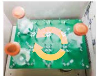
一定時間毎に回転方向を反転させる回転振盪機
