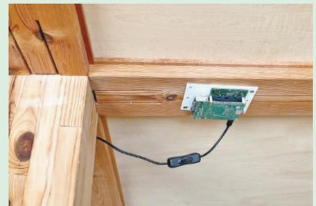
図2 住宅の梁に取り付けられた加速度計の例
