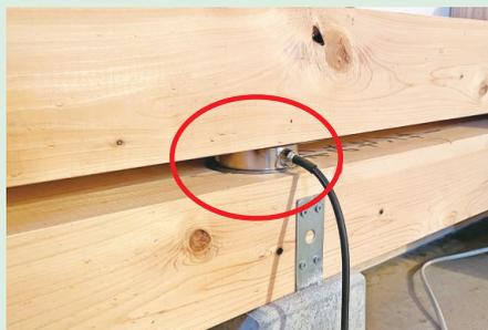
図3 実験棟に設置されたロードセル(荷重計)
