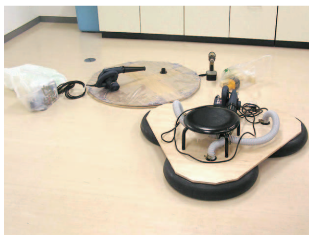
図4 製作した小型ホバークラフト
