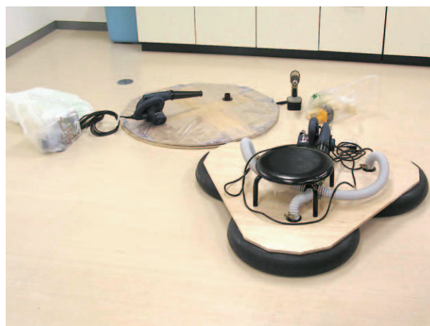
図4 製作した小型ホバークラフト
