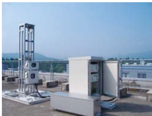
本学屋上に設置した大気中形態別水銀濃度測定装置
