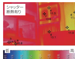
断熱対策の有無による右側のシャッターと左側の金属部品周辺の断熱効果の違い
