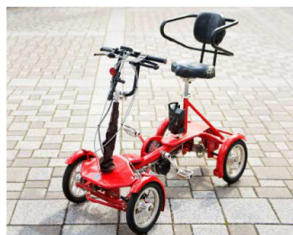
図1 足漕ぎ4輪型電動アシスト式移動支援機器
