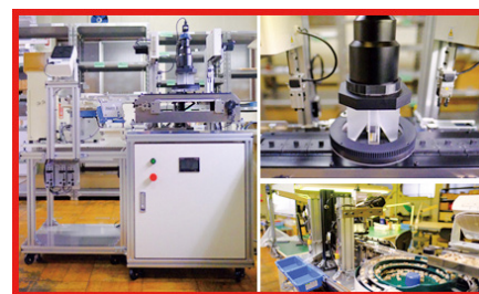
AI自動検査装置の外観
