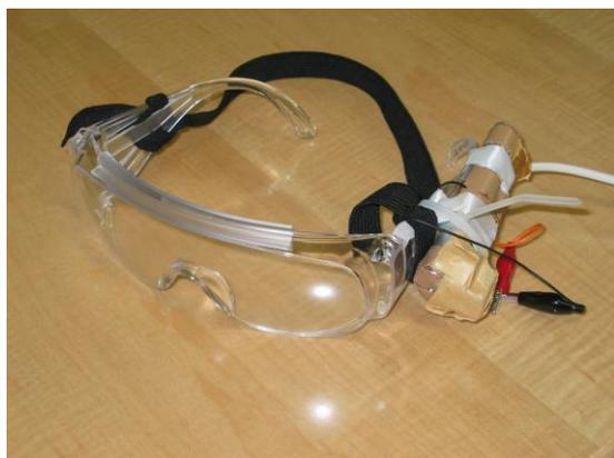
四肢麻痺者用入力装置試作機 (レーザー光による指示)。
