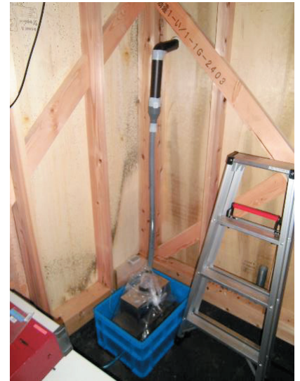
11 建物モデルに雨桶を設置して、屋根流水の計測も行っている
