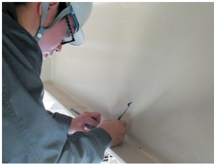
3 体育館へのひずみゲージ貼り付け
