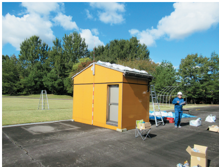
6 長岡に建つ木造の建物モデル。土嚢実験の様子
