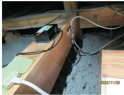
4 計測に使う加速度センサ
